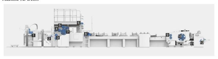
T 飞达 Feeder ■ 前侧规定位系统 Front And Side Guides Positioning System ■ 开口切角系统 Edge Cutting System 4. 头卡上胶系统 Reinforced paper gluing system 図 貼手挽系统 Handle pasting system Servo reinforce out off system
